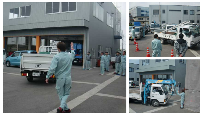
4/28若手社員に運転講習を行いました(上写真3枚)作業車をバックさせる誘導実習です。運転手に見える位置で声を出す指導をしています。先輩の誘導方法を真似ながら頑張っていました。
